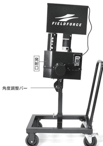
マシン本体の角度を調整する時は必ず片方の手でマシン本体を支え、もう片方の手で角度調整バーを解除し角度調整を行ってください。角度調整バーは、左に回せば解除され右に回せば固定されます。
